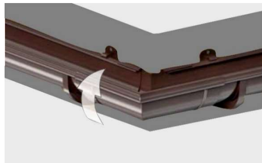
Fot. 4-32. Montaż narożników.
