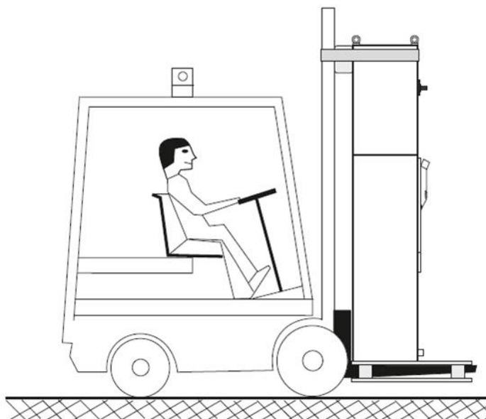
Rys. 4 Przenoszenie wózkiem widłowym
