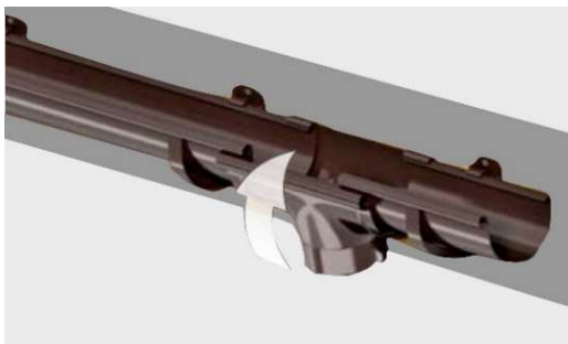
Fot. 4-30. Montaż leja spustowego.
