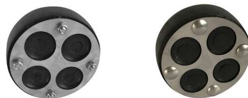
Fot. 6-13. Wkład uszczelniający wielokablowy do uszczelniania kabli sterowniczych, średnica 100 mm APW3-100/30/4x15÷30/K.
