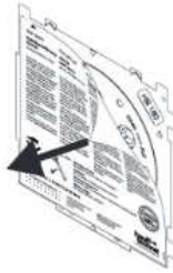
Fot. 6-36. Folia ochronna przepustu.
