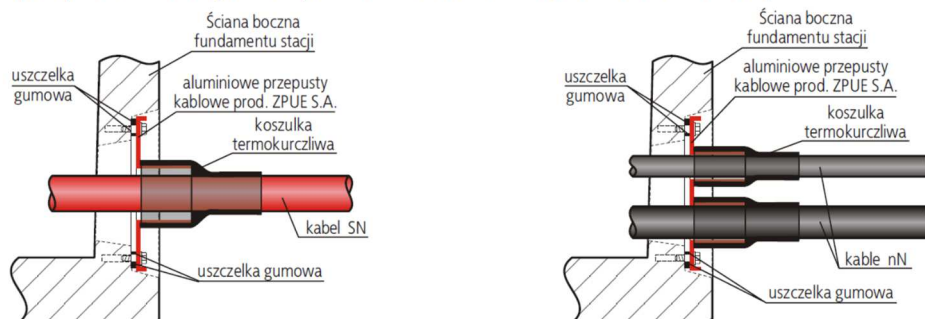
Rys. 6.3 Rodzaje przepustów ZPUE SA, uszczelnienie kabli
