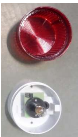
Fot. 4-17. Demontaż klosza lampy sygnalizacyjnej.
