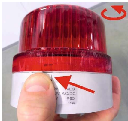
Fot. 4-16. Demontaż klosza lampy sygnalizacyjnej.
