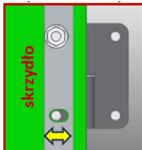
Rys. 11.1 Widok zawiasów – strona wewnątrz stacji
