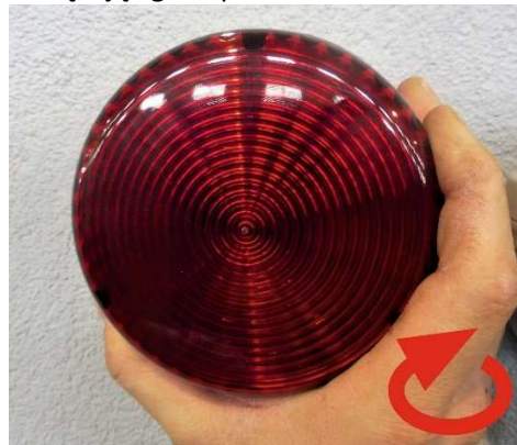
Fot. 4-24. Montaż klosza.
