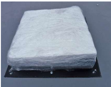
Fot. 4-45 Podstawa wentylatora zabezpieczona na czas transportu
