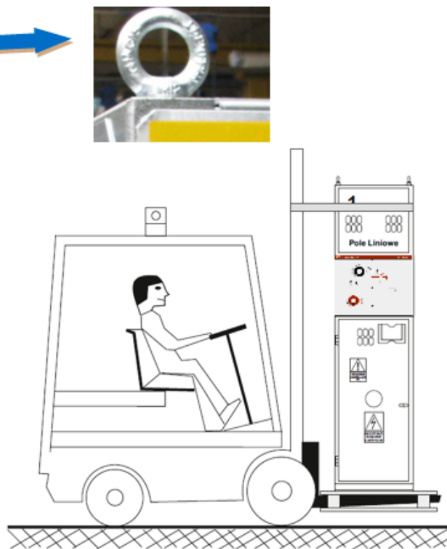
Rys. 10 Przenoszenie wózkiem widłowym.
